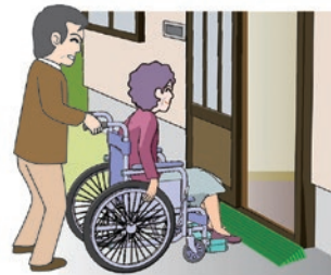
屋外での段差解消
