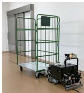
AGVによる出庫
