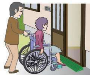
屋外での段差解消
